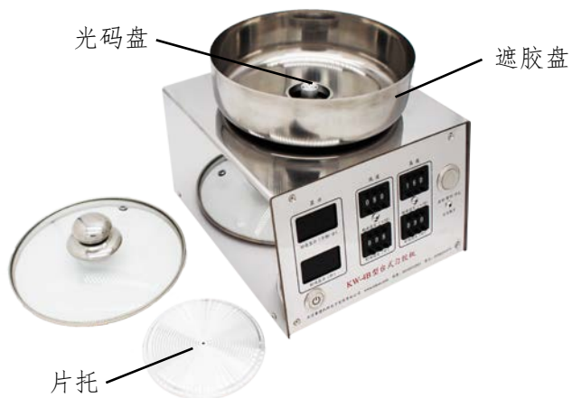
图 2 匀胶机安装示意图
